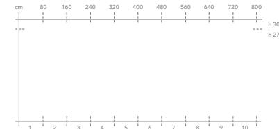
La dimensione del rotolo standard ha un'altezza di 270 cm o 300 cm. Nella misura standard vengono previsti 5 cm di abbondanza nella parte superiore e 5 cm nella parte inferiore del rotolo. Si rientra quindi nella dimensione standard tra i 260 e i 310 cm.
